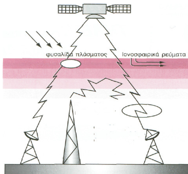
Σχήμα 2.6 Δορυφορική μετάδοση ΗΜ κυμάτων και επηρροές από το περιβάλλον διάδοσης
