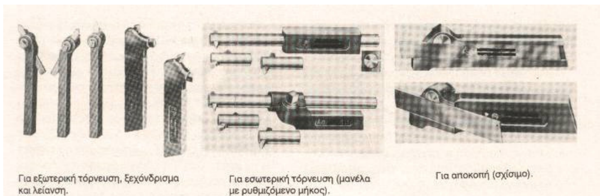
Σχήμα 2.30 Εργαλεία με ραβδία (ατσαλάκια) από ταχυχάλυβα σε κατάλληλες μανέλες.
