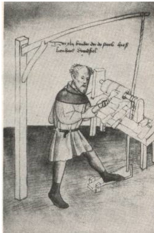
Σχήμα 2.1 Πραγματοποίηση της ιδέας του τórνου από το έτος 1395.
