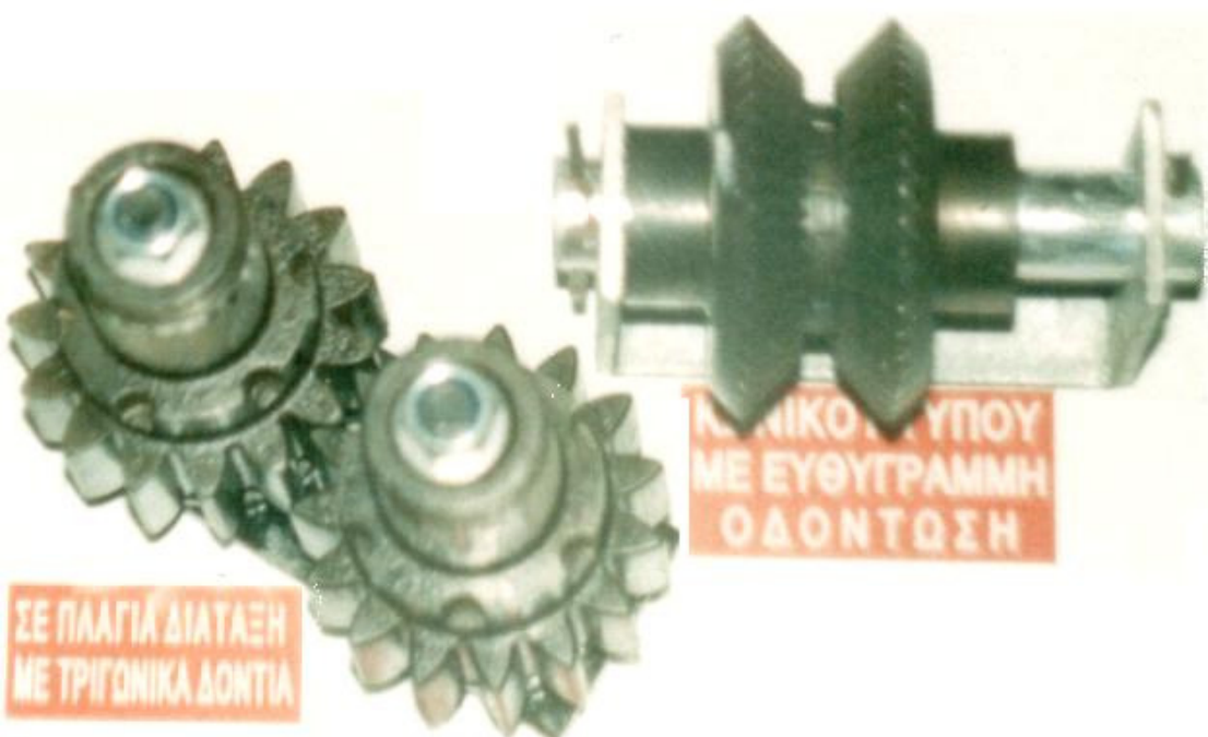
ΣΕ ΟΡΙΖΩΝΤΙΑ ΔΙΑΤΑΞΗ ΜΕ ΕΥΘΥΓΡΑΜΜΗ ΟΔΟΝΤΩΣΗ ΚΑΙ ΔΥΝΑΤΟΤΗΤΑ ΜΕΤΑΒΟΛΗΣ ΚΙΝΗΣΗΣ ΜΕ ΙΜΑΝΤΑ
