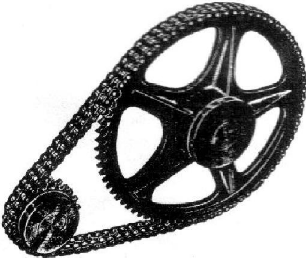
Σχήμα 2.4.17. Αλυσοκίνηση με τροχαλίες διπλής οδόντωσης και διπλή αλυσίδα
