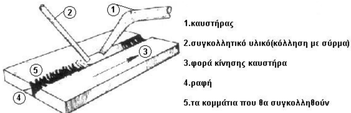
Σχήμα 1.4.1. Συγκόλληση με φλόγα ασετυλίνης - οξυγόνου
