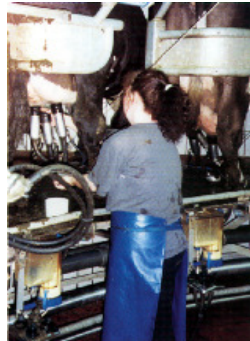
Εικόνες 2.4-2.5:Περιστροφικό μηχάνημα τύπου ψαροκόκαλο
