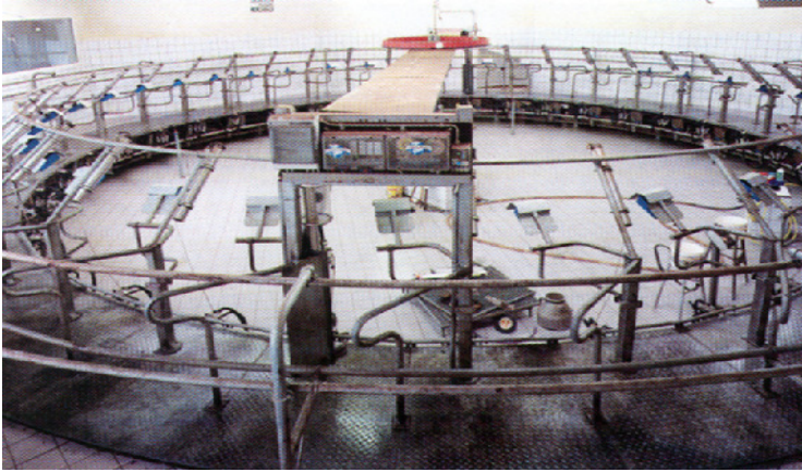
Εικόνες 2.4-2.5:Περιστροφικό μηχάνημα τύπου ψαροκόκαλο
