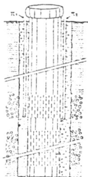
Σχ.35 Πιεζομετρικοί σωλήνες υδρογεωτρήσεων : με φίλτρο ( \Pi_1 ) και χωρίς φίλτρο κολλητός στη σωλήνωση ( \Pi_2 ).
