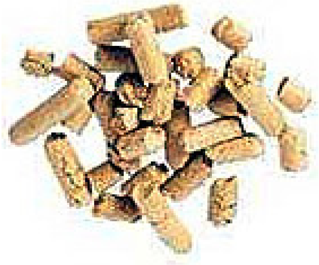
Σχήμα 2.5 Υλικό από βιομάζα για καύση σε ειδικό καυστήρα βιομάζας
