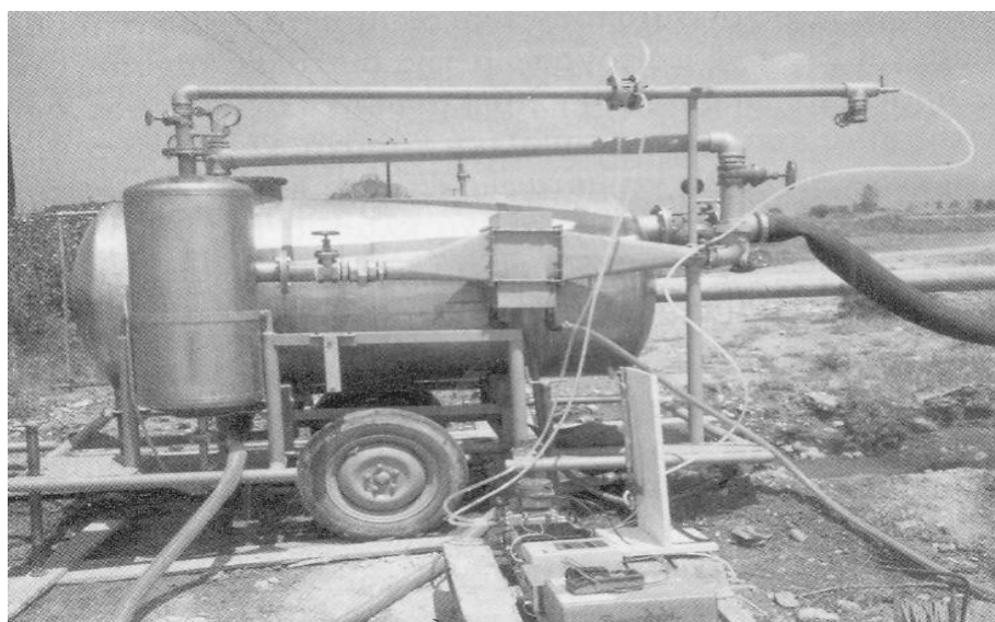
Σχήμα 4.7 Φωτογραφία της κινητής διάταξης διαχωρισμού των δύο φάσεων, που χρησιμοποιήθηκε σε αρκετές γεωτρήσεις χαμηλής ενθαλπίας.
