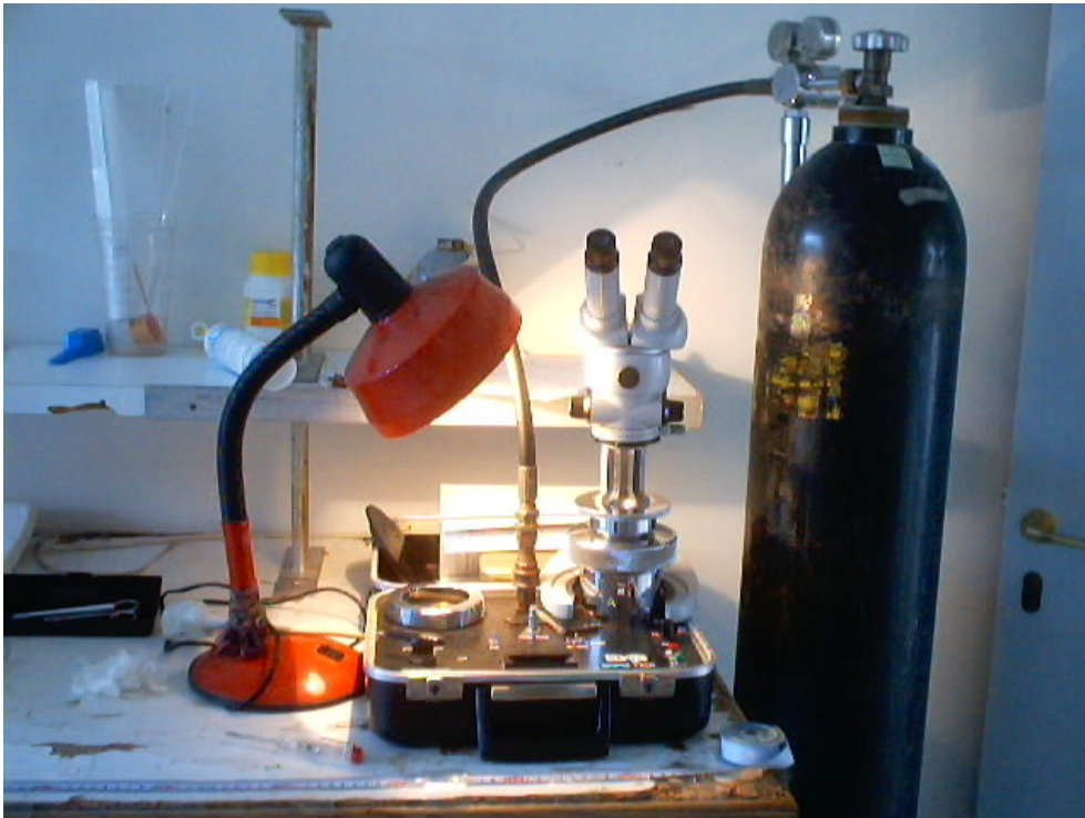
Εικόνα 37. Διάταξη ενός οργάνου πιεστικού θαλάμου. (Από το πείραμα που πραγματοποιήσα)
