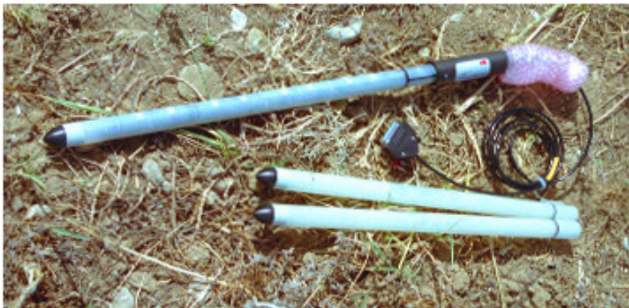
Εικόνα 11. Αισθητήρας για τη μέτρηση της εδαφικής υγρασίας. (Από το αρχείο του εργαστηρίου της Φυσιολογίας των φυτικών καλλιεργειών του Πανεπιστημίου Πατρών).
