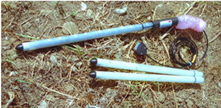
Εικόνα 47. Αισθητήρας για τη μέτρηση της εδαφικής υγρασίας. (Από το αρχείο του εργαστηρίου της Φυσιολογίας των φυτικών καλλιεργειών του Πανεπιστημίου Πατρών).
