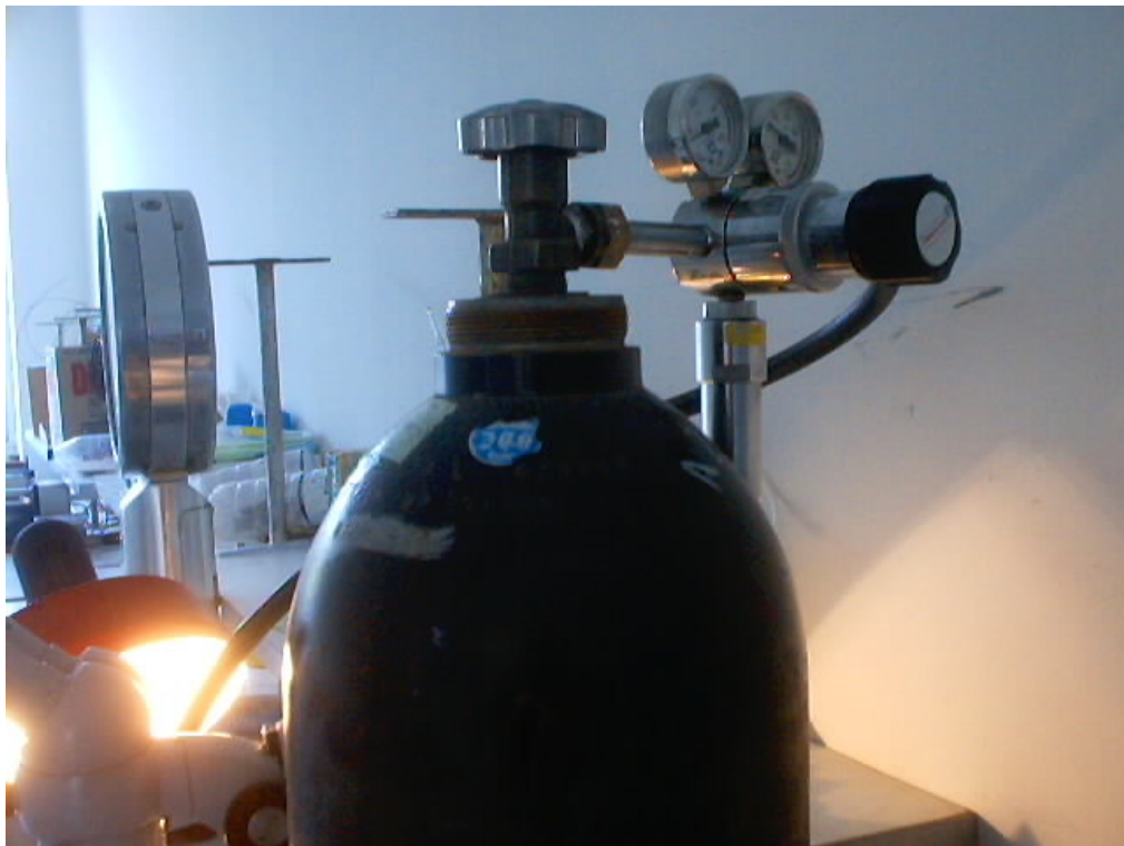
Εικόνα 39. Φιάλη που περιέχει άζωτο υπό πίεση με της ρυθμιστικές βαλβίδες και τα μανόμετρα. (Από το πείραμα που πραγματοποιήσα)
