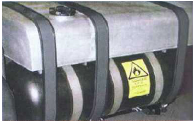
Εικόνα 3.1 Δεξαμενή Diesel επάνω και LPG κάτω με χωρητικότητα 350lt
