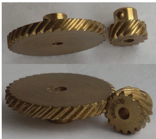
Εικόνα 3.4-2 : Εμπλοκή ελικοειδών γραναζιών
