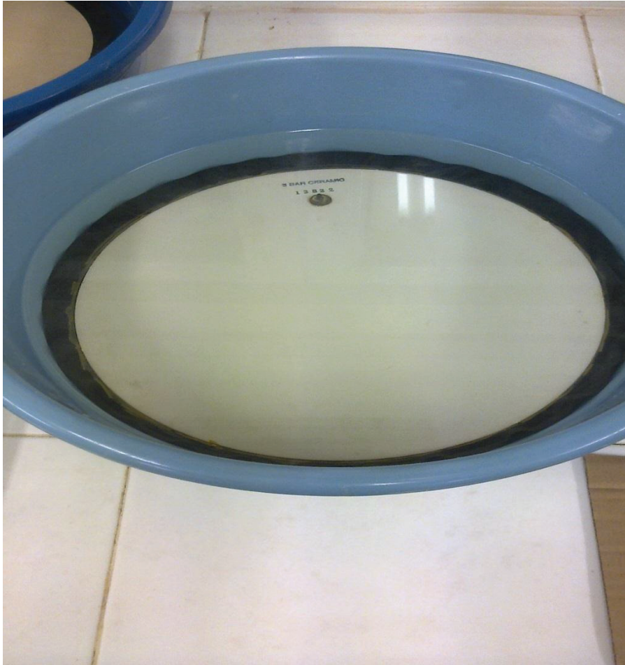
Εικόνα 5. 19: Κορεσμός πλάκας μέσα στη λεκάνη.
