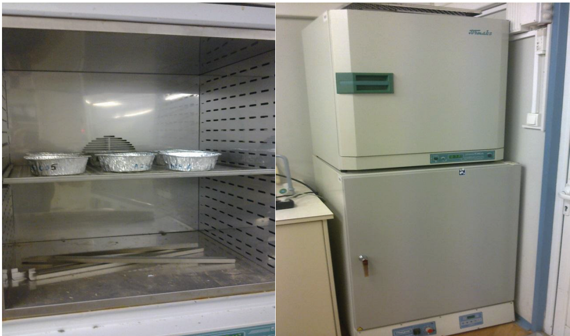
Εικόνα 5. 24: Τοποθέτηση δειγμάτων στο πυριαντήριο στους 105°C.
