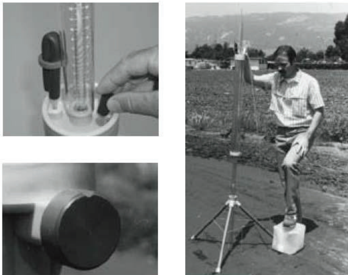
Εικόνα 4.14 Γέμισμα της δεξαμενής με νερό χρησιμοποιώντας το πτυσσόμενο δοχείο νερού
