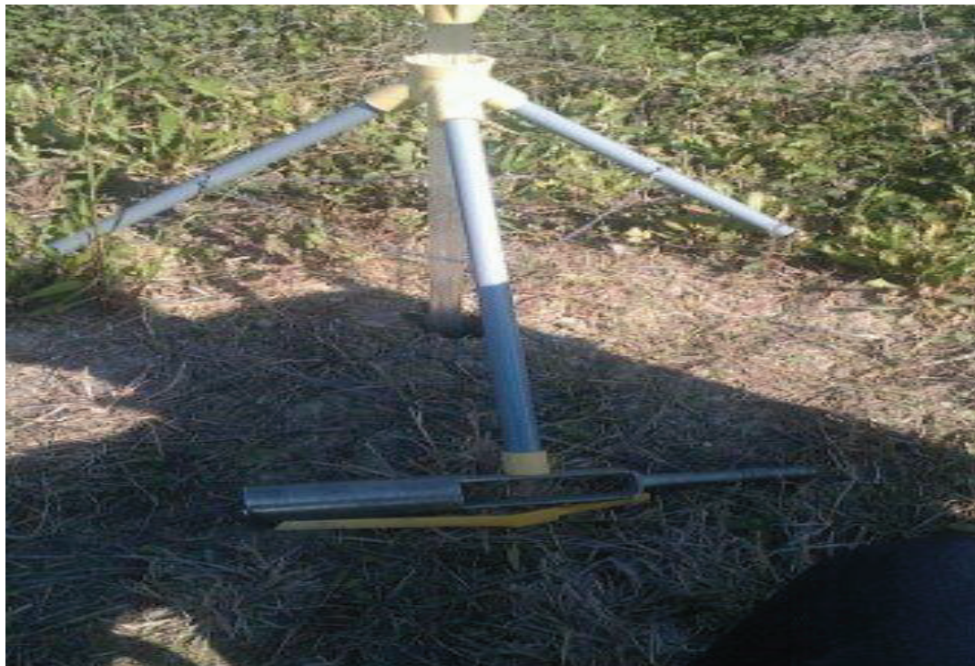
Εικόνα 5.6 Τοποθέτηση περατόμετρου στο σημείο 5
