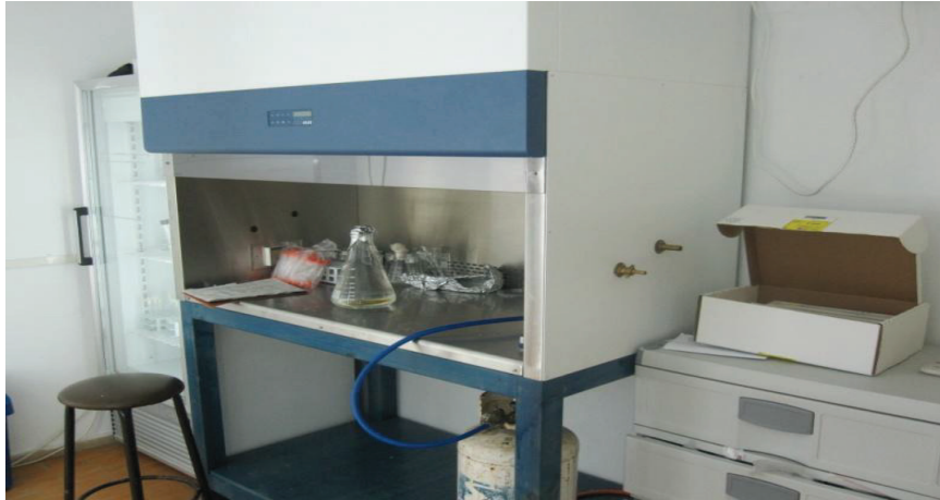
Εικόνα 12: Αποστειρωμένος χώρος εργασίας. Δοακρίνεται στη βάση, η φιάλη υγραερίου για τη χρήση του αυτόκαυστου (πηγή: φωτογραφία από την συγγραφέα).
