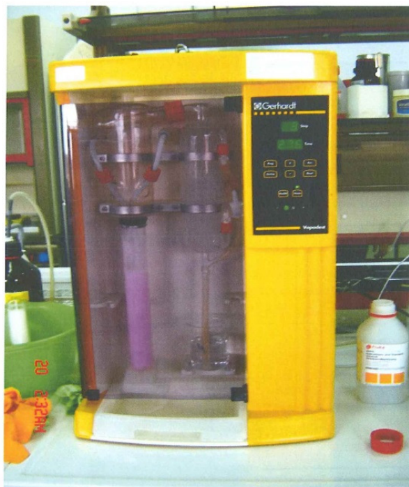
Εικόνα 4. Μονάδα απόσταξης ατμού - Προσδιορισμός TVB
